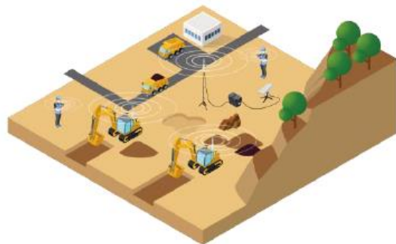
（“通信不感地対策Wi-Fiパック”を設置した現場）
